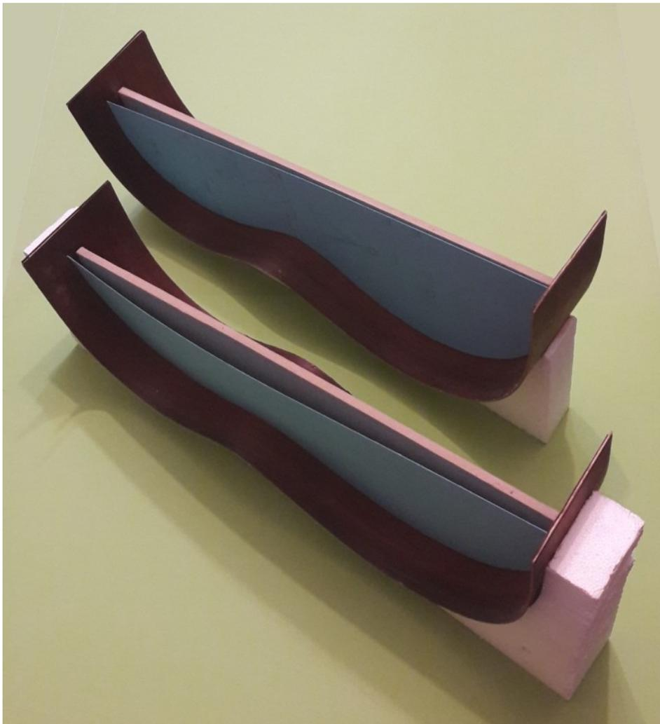
Die Zargen der aktuell VIERTEN konnten leicht mit Teilen der beiden alten Schablonen gebogen werden. Weil sich die max. 7 mm dünnen Brettchen schon leicht aus der Hand biegen lassen.
