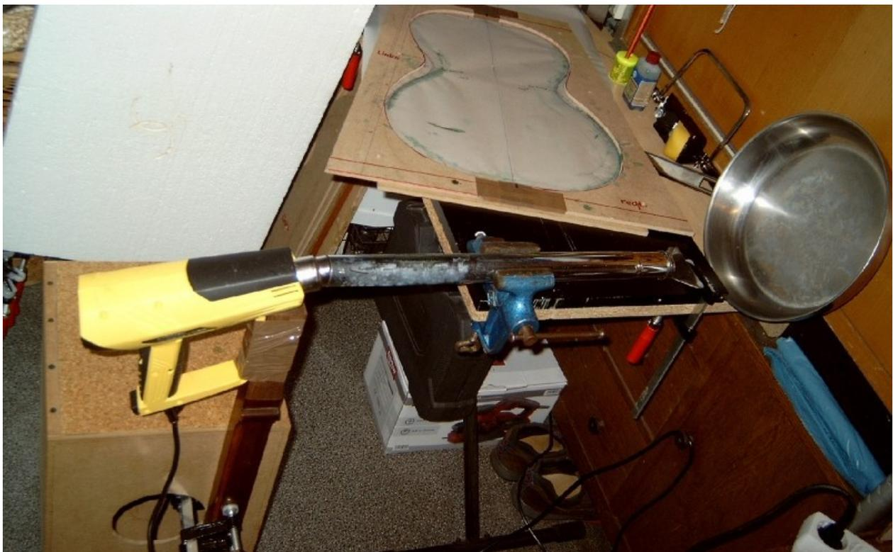
Den oben gezeigten händischen Falzschneider habe ich in Verbindung mit dem Kreisschneider zu einer Falzfräse mit Anlauftring weiter entwickelt.
