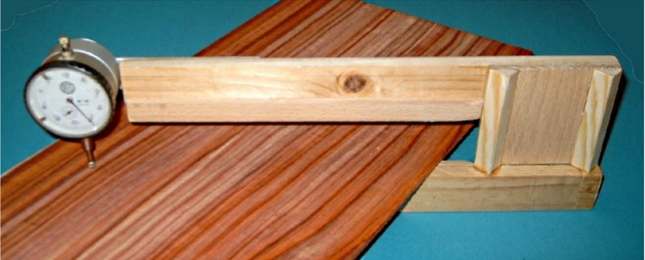
Die 1/100 Messuhr, hat auf ihrer Rückseite einen starken Dauermagneten, deshalb der Metallstreifen am oberen Arm, dort wird die Uhr einfach angeklickt.
