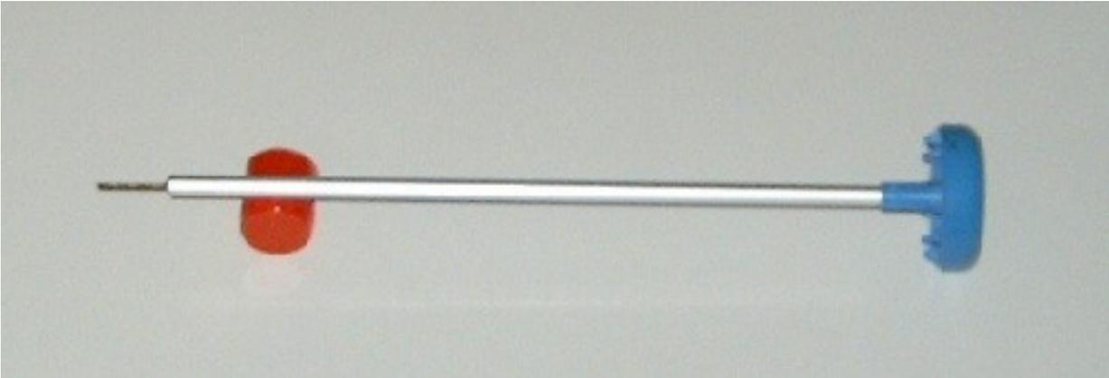
Der Bohrer hat einen Durchmesser von 2 mm, der Aluminium Rundstab einen Durchmesser von 6 mm und eine Länge von 200 mm.
